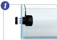
Ajuste a direção do corpo da bomba de ondas na ventosa de posicionamento e instale-a abaixo de 15/20 cm do nível da água. Em seguida, posicione a outra metade magnética fora do aquário com a bomba dentro do aquário.
