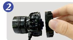
Separe a metade magnética e remova o corpo principal da bomba de ondas do aquífero. Seque-o, remova a tela do filtro, lave o impeller e o corpo da bomba. Depois, recoloque a tela de filtragem e reinstale.
