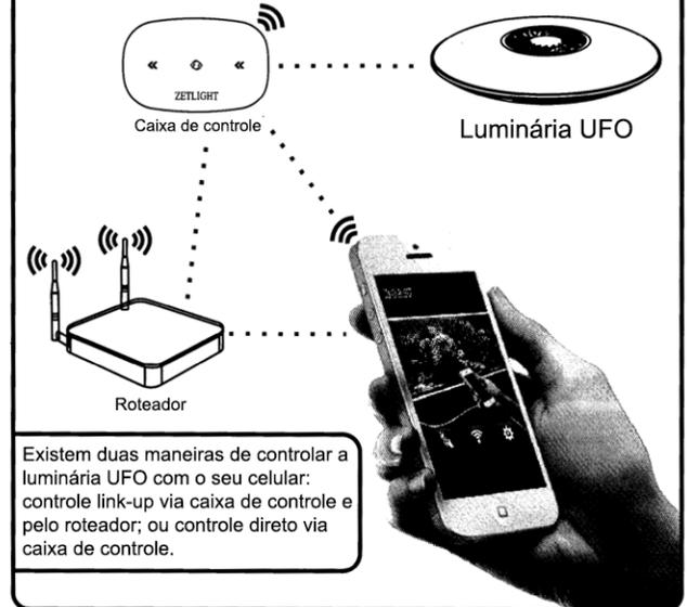
Existem duas maneiras de controlar a luminária UFO com o seu celular: controle link-up via caixa de controle e pelo roteador; ou controle direto via caixa de controle.
